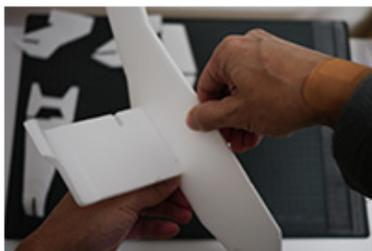
主翼を前後から挟むように、本体を組み合わせてセロハンテープで止めます。
